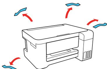
2 Levante a unidade do scanner. Remova todos os materiais de proteção de dentro do produto.
