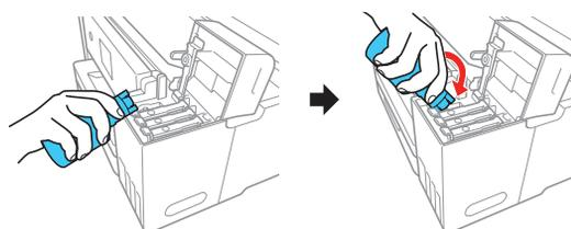
**Observação:** Consulte os adesivos coloridos na unidade do tanque de tinta para identificar a cor de cada tanque. Não force as garrafas no lugar; elas são feitas para encaixar nas suas respectivas cores.
