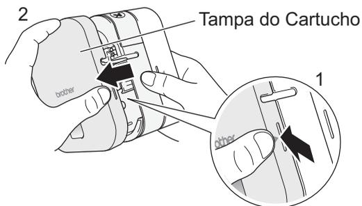
2. Insira o Cartucho de Fita de acordo com o desenho marcado dentro da caixa. Confirme se a fita está voltada para a Saída de Fita verde e pressione suavemente o Cartucho de Fita no rotulador eletrônico até encaixá-lo no lugar.
